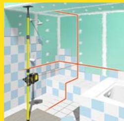
Формирование вертикальной проекции от пола до потолка
