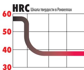
Индукционная закалка не допускается на рабочих частях, которые участвуют в передаче вибрации на рукоятку. Более мягкая сталь ослабляет вибрацию.
