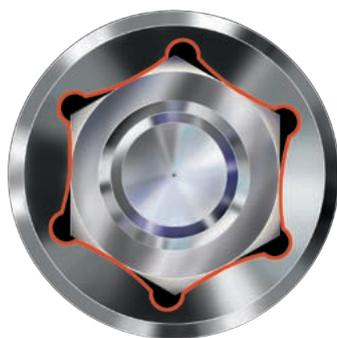
При использовании головок с данным профилем основное усилие прикладывается к средним частям граней гайки, а не к их углам, поэтому к крепежу можно прикладывать больший момент при минимальном риске повреждения крепежа или головки.
