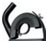
Защитный колпак всаса с салазками для отрезных кругов Ø 180 мм, глубина реза 40 мм, примыкание Ø 32 мм
