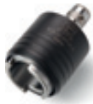
Патрон для быстрой смены инструмента для нарезания резьбы, для KBM 50 Q, KBM 50 U, KBM 52 U, KBM 65 U Используется только для станков корончатого сверления с функцией левого вращения. Размер 2, хвостовик QuickIN, для метчика, в сочетании с насадками для нарезания резьбы может быть оснащен предохранительной муфтой от М6 до М20.
