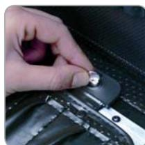
Фиксация панели с помощью поворотной защелки
