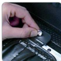
Фиксация панели с помощью поворотной защелки
