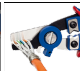
Резание внутреннего проводника
