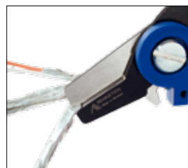
Резание экрана витой пары
