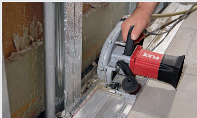
Бесступенчатое установление глубины резания 0-60 мм (с направляющей шиной 0-54 мм) в особенности подходит для изготовления деформационных швов и чистовой отделки ребер при изготовлении полов.
