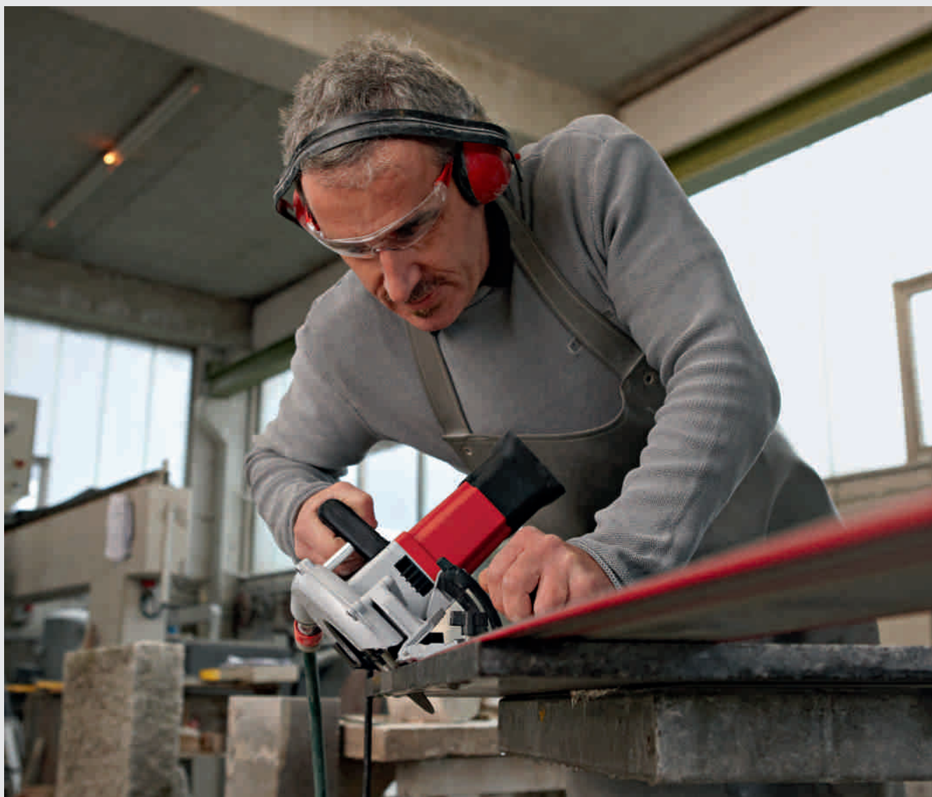
Новой алмазной пилой для распиловки камней FLEX CS 60 WET можно не только производить чистую и точную резку, но и производить косую распиловку под углом 0-45°.
