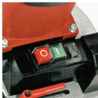
Аварийный выключатель для предотвращения случайного включения после сбоя электроснабжения.
