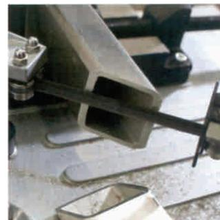
Направляющая пильной ленты на трех шариковых опорах для оптимального процесса резки.
