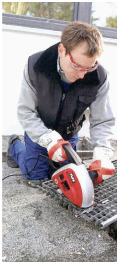
*Точное пиление металла без охлаждающей жидкости. Практически без заусениц и минимальной искрой.*
