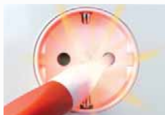
Пробник распознает фазу и нулевой провод.
