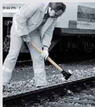
Безопасные оболочки из ковкого чугуна с порошковым покрытием надежно соединяют головку и рукоятку. Кувалда длиной 840 мм – идеальный инструмент для специальных областей применения, например, при укладке железнодорожных путей.
