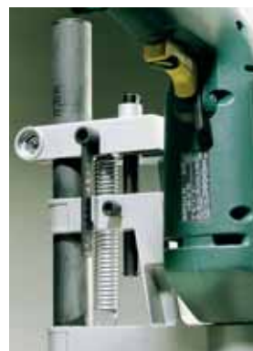
установка глубины сверления с помощью упора ограничения глубины
