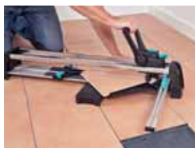
специальная направляющая для диагональных разрезов
