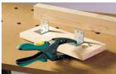
большая глубина зажима позволяет также зажимать области, расположенные далеко от краев
