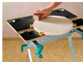
прихваты из пластика для зажима плоских деталей
