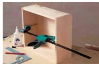
просто выполняемое переоборудование для функции распора
