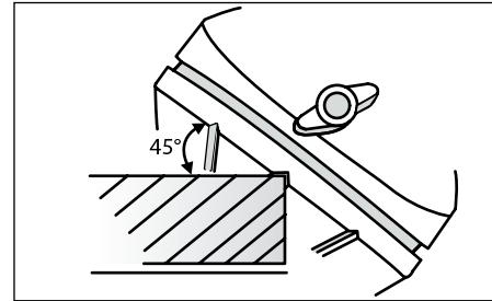
Не прилагайте излишних усилий при нажатии на изделие. Необходимость увеличения усилия свидетельствует о затуплении ножей. Строгание с большим усилием ведет к перегреву изделия и преждевременному выходу его из строя.
