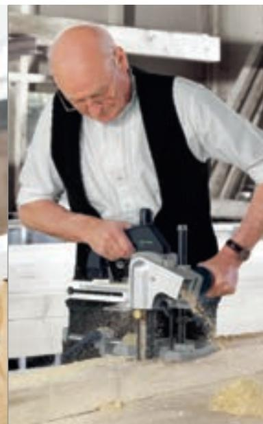
Снимаем пильный диск и ставим фрезу: благодаря фрезе для выборки клиновидного паза дисковая пила НК 132 Е без особых проблем превращается в надёжный плотницкий фрезер.
