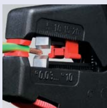
Прецизионное удаление изоляции без повреждения проводника
