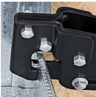
Установка инструмента на оба соединяемых профиля
