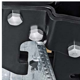
Пуансон инструмента продавливается через профили
