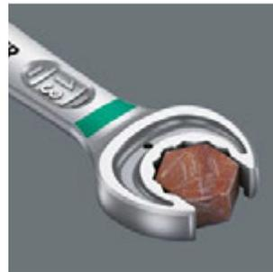
Геометрия двойного шестигранника рожкового ключа Joker обеспечивает геометрическое замыкание с болтом или гайкой. А сменная, закаленная металлическая пластина в зеве ключа вцепляется очень прочными зубцами в болт. Все это предупреждает неприятное соскальзывание даже при больших моментах затяжки.
