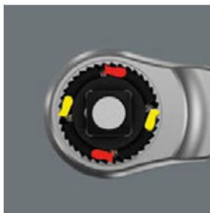
Благодаря двойной зубчатой защелке 38 прочных зубьев сравнимы по эффекту точной механики с соединением из 76 мелких зубцов, дающим угол возврата в 4,7°.
