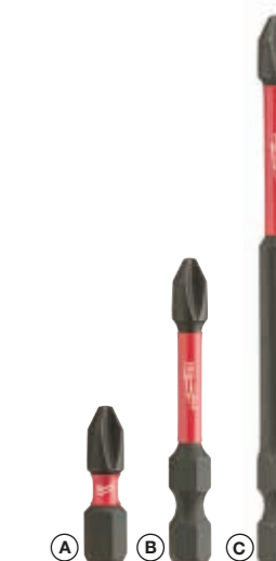
A) 25 мм 1/4" Hex - DIN 3126 - C 6.3 B) 50 мм 1/4" Hex - DIN 3126 - E 6.3 C) 90 мм 1/4" Hex - DIN 3126 - E 6.3
