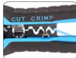
Опрессовка неизолированного наконечника
