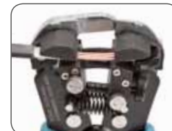
Одновременное снятие изоляции с трех проводов
