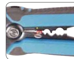
Опрессовка изолированного наконечника
