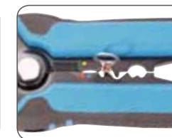
Опрессовка неизолированного наконечника
