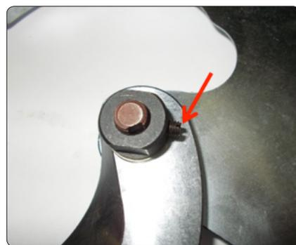
5. Вытащите винт с установленной в нем шпонкой. Снимите подвижное лезвие.
