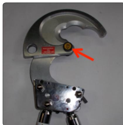
**19.** После того как гайка подтянута с требуемым усилием, закройте лезвие и установите его в среднее положение, как показано на фото.
