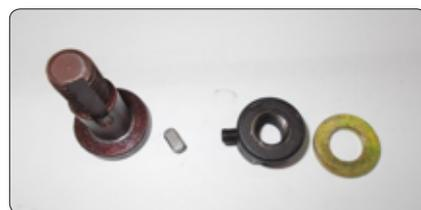
6. Открутите все гайки и снимите стопорное кольцо с оси подвижной рукоятки.
