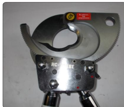
**20.** При помощи шестигранника ослабьте два крайних фиксирующих винта прижимной планки. При помощи тонкой отвертки закрутите регулировочные штифты, тем самым плотно прижав планку к подвижному лезвию. Затяните фиксирующие винты.
