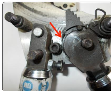
10. Удалите возможную грязь и старую смазку со всех деталей, желательно промыть все детали нефрасом (бензином) или любой другой промывочной жидкостью.
