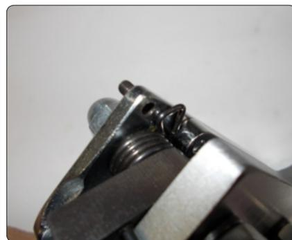
8. Теперь аккуратно потяните вверх крышку храпового механизма и снимите ее.
