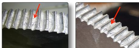
Грязь мешает полноценному зацеплению зубьев храповика и подвижного лезвия, что приводит к их преждевременному износу.
