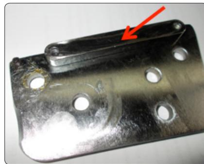
**18.** Плотно затяните гайку соединительного винта лезвий так, чтобы при открытом подвижном лезвии не было люфта в соединении ножей, т.е., чтобы подвижное лезвие не болталось на винте, но и не было перетянута. Лезвие должно двигаться не свободно, а с легким натягом.
