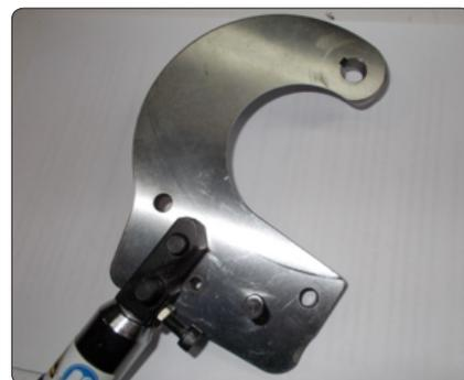
6. Снимите храповик и втулку храповика с подвижной рукоятки, промойте и осмотрите втулку и посадочное место под нее на рукоятке на наличие сильной выработки.
