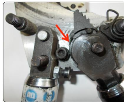
4. Удалите возможную грязь и старую смазку со всех деталей, желательно промыть все детали нефрасом (бензином) или любой другой промывочной жидкостью.
