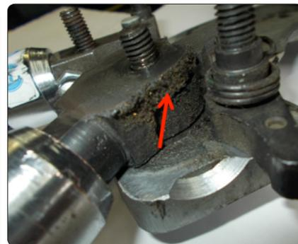
5. Снимите подвижную рукоятку вместе с храповиком, стопорную собачку, и, если необходимо, то и пружину храповика и опять промойте, удалив остатки старой смазки и грязи.
