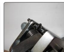
Теперь аккуратно потяните вверх крышку храпового механизма и снимите ее.
