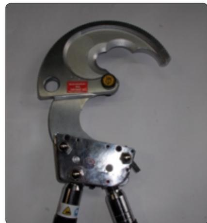
Открутите все гайки и снимите стопорное кольцо с оси подвижной рукоятки.
