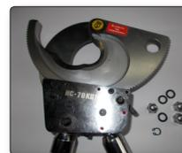
В правом верхнем углу передней крышки находится маленький винт, который является стопором для пружины собачки. Выкрутите его при помощи шестигранника, чтобы ослабить пружину стопорной собачки.
