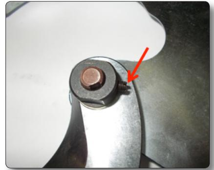
5. Вытащите винт с установленной в нем шпонкой. Снимите подвижное лезвие.
