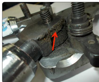
11. Снимите подвижную рукоятку вместе с храповиком, стопорную собачку, пружину храповика и неподвижную рукоятку.
