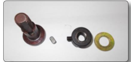
6. Открутите все гайки и снимите стопорное кольцо с оси подвижной рукоятки.
