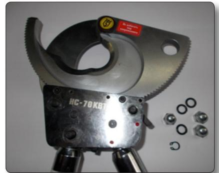
7. В правом верхнем углу передней крышки находится маленький винт, который является стопором для пружины собачки. Выкрутите его при помощи шестигранника, чтобы ослабить пружину стопорной собачки.
