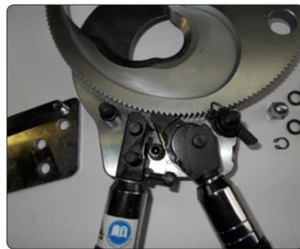
9. Осмотрите храповой механизм, теперь вам видна еще и пружина храповика. Если пружина храповика сломана, погнута либо ослабла и плохо поджимает храповик к лезвию, то ее также необходимо заменить.
