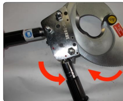
2. Потяните за тонкий конец лезвия по часовой стрелке и проверните так, чтобы оно полностью вышло из зацепления и с собачкой, и с храповиком.
