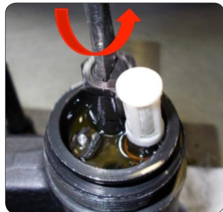
6. Теперь необходимо выставить оптимальное давление, при котором АСД будет срабатывать, и обеспечивать необходимое усилие сжатия матриц. Для этого надо повернуть регулировочный винт клапана АСД по часовой стрелке. Делать это следует аккуратно, т.к. даже поворот винта на 90° увеличивает усилие ориентировочно на 10 Мпа. Поэтому увеличивать давление следует постепенно, поворачивая винт каждый раз не более чем на 30°.
