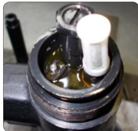
5. Выкрутите регулировочный винт на один оборот (360°) против часовой стрелки, тем самым значительно уменьшив величину создаваемого давления.
