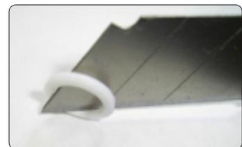
При помощи ранее изготовленных крючков, установите резиновое кольцо в нижний паз узкого канала, а за ним в тот же паз установите фторопластовое кольцо. Резиновое кольцо должно быть ниже фторопластового.
