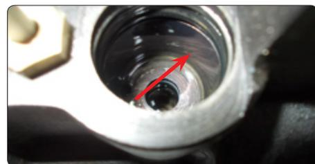
7. Если поверхности плунжера и цилиндра не имеют повреждений, можно приступить к замене колец. Удалите старые кольца, используя ранее изготовленные приспособления. Удалите два верхних резиновых кольца из пазов широкой части, одно резиновое и одно фторопластовое кольцо из узкой части.
