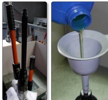
Для того, чтобы пресс в дальнейшем функционировал нормально, необходимо полностью стравить весь воздух из системы. Возьмите шлицевую отвертку, надавите на шток клапана сброса давления и сделайте 8–10 качков подвижной рукояткой при нажатом клапане.
