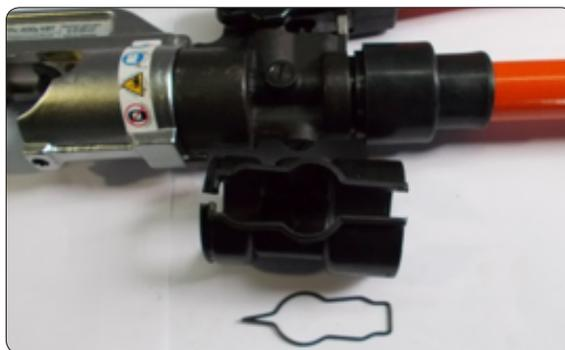
2. Открутите неподвижную рукоятку против часовой стрелки. Внутри корпуса неподвижной рукоятки находится резиновая емкость, заполненная гидравлическим маслом. Это масло необходимо слить, во избежание его попадания на одежду в процессе ремонта.
