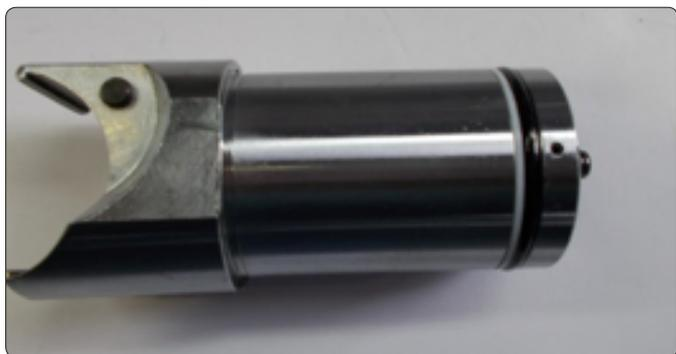
11. Установите шток с новыми кольцами обратно в корпус. Будьте осторожны! Не повредите кольца о края корпуса. Для облегчения задачи слегка смажьте кольца маслом. Теперь, надавливая на шток и тем самым сжимая возвратную пружину, закрутите шток в корпус по часовой стрелке. Закрутив шток до упора, сделайте пол оборота назад, чтобы у штока был небольшой запас свободного вращения. Наверните рабочую голову, вставьте и зафиксируйте направляющий вкладыш, вкрутите ограничители поворота рабочей головы.
