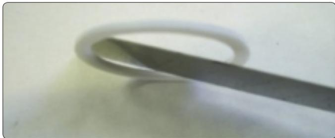
После того как Вы разрезали фторопластовое кольцо, установите в паз штока сначала резиновое кольцо, а затем разрезанное фторопластовое. Будьте внимательны при установке колец, они должны быть установлены именно в той последовательности, как показано на фото. В противном случае, после первой же опрессовки, кольца придется снова менять местами.
