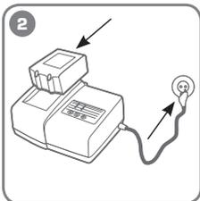
**2** Убедитесь, что температура окружающего воздуха в помещении 10-40°C. Вставьте аккумулятор в зарядное устройство, а штекер в розетку 230 В/50 Гц
