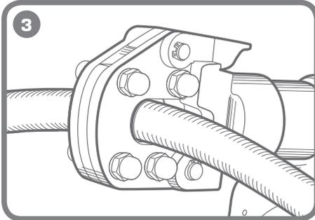
**3** Нажмите на кнопку «ПУСК» и держите нажатой ее до срабатывания механизма автоматического сброса давления. При этом раздается характерный щелчок.
