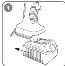
**1** Вставьте аккумулятор обратно в корпус инструмента до щелчка.
