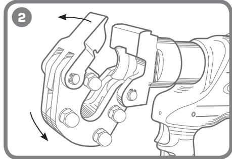
**2** Откройте рабочую голову, нажав на фиксатор. Установите трос или пруток в рабочую зону. Закройте рабочую голову, защелкнув фиксатор.
