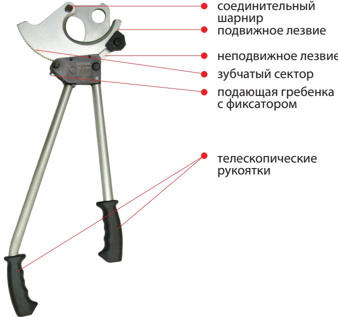
Основные детали секторных ножниц НС-80БС представлены на рисунке. Перерезание кабеля с помощью этих ножниц осуществляется в ходе поворота подвижного лезвия вокруг соединительного шарнира. Благодаря оригинальной геометрии лезвий в каждый момент реза достигается равномерное всестороннее воздействие режущего контура на разрезаемый участок. Это обеспечивает точность реза, минимальную деформацию и отсутствие «вытягивания» жил кабеля.
