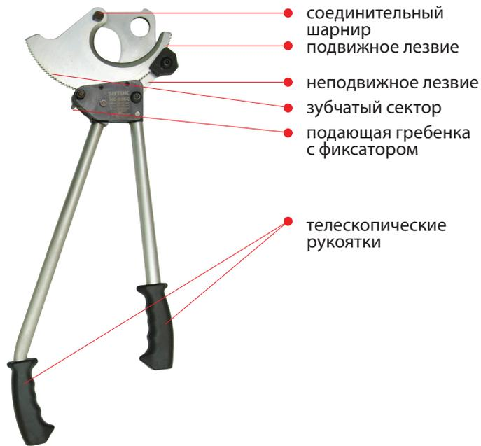
Основные детали секторных ножниц НС-80БС представлены на рисунке. Перерезание кабеля с помощью этих ножниц осуществляется в ходе поворота подвижного лезвия вокруг соединительного шарнира. Благодаря оригинальной геометрии лезвий в каждый момент реза достигается равномерное всестороннее воздействие режущего контура на разрезаемый участок. Это обеспечивает точность реза, минимальную деформацию и отсутствие «вытягивания» жил кабеля.
