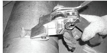
4. Переверните инструмент чтобы зафиксировать ленту. Поверните рукоятку резака, чтобы обрезать излишек ленты.
