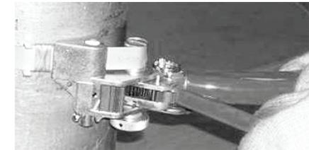
3. Переверните инструмент чтобы зафиксировать ленту. Поверните рукоятку резака, чтобы обрезать излишек ленты.
