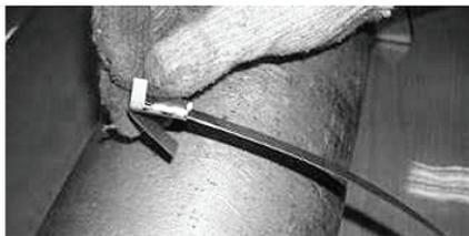
2. Оберните ленту вокруг опоры и вставьте ее через нос инструмента в прорезь барабана.
