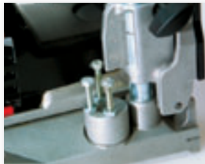
Глубина паза устанавливается как по револьверному упору, так и по шкале.
