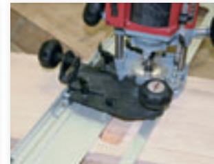
Фрезерное устройство для пазов 640 x 60 мм.
