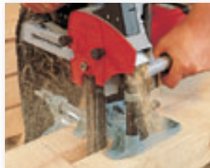
LS 103 Ес с направляющей стойкой FG 150 глубина выборки – 140 мм.
