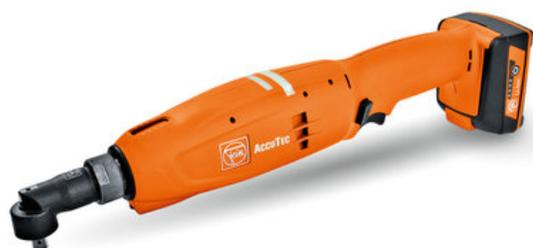
Программируемый нормируемый винтоверт в соответствии со стандартами ISO 5393, VDI/VDE 2647, значение CMK > 1,67 при  $\pm 10\%$  (при 6 сигма).
