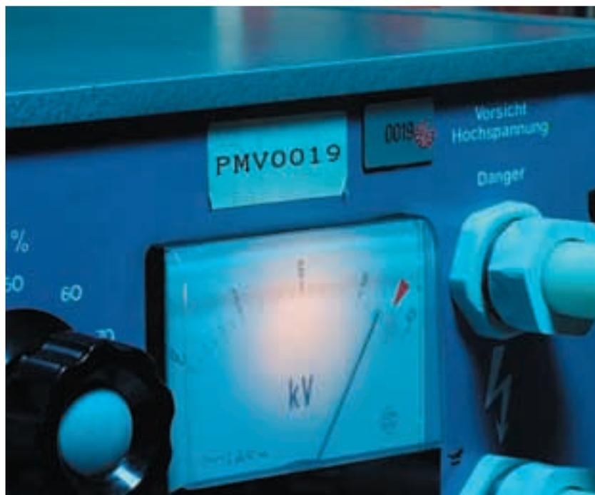
*Индивидуальный контроль в условиях водяной бани при 10000 Вольт согласно стандарту DIN EN 60900 (IEC 60900 : 2004). Гарантированная безопасность работы при напряжении до 1000 Вольт.*
