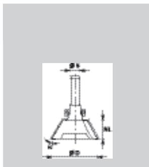
Фреза HW для снятия фаски с режущей кромкой вниз
