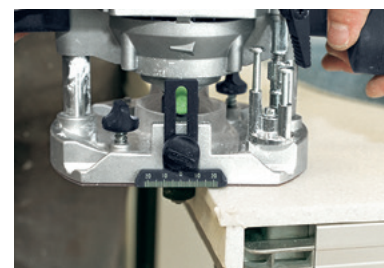
Фреза пригоночная с нижним опорным подшипником, хвостовик 12 мм HW s = 12
