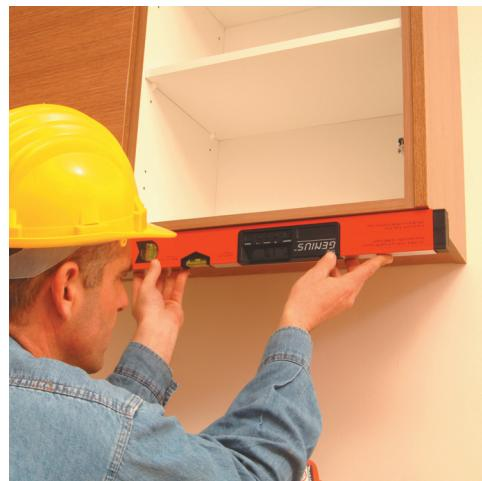
Автоматическое переворачивание шкалы при работе
