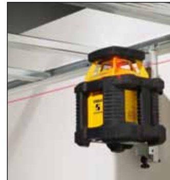
Нивелирная консоль, Тип NK 100 Идеально подходит для выполнения работ в области внутренней отделки: Нивелирная консоль с регулировкой высоты (приспособление для крепления на стене) для ротационного лазерного прибора. Подвешивается на профильной шине или на гвозде. Спектр применения: установка наклонных конструкций потолков, бесшовных покрытий пола.
