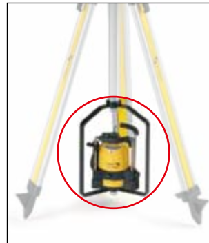
Скоба для крепления на штативе, Тип SB Для установки ротационного лазерного прибора над полом. Монтаж производится на удлинительном штоке BST-K-XL в позиции хранения. Регулировка высоты осуществляется с помощью кривошипного механизма.
