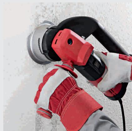
Покрытые краской обои вскрываются с помощью зуборезных долбачков модернизированного перфоратора. Благодаря этому жидкость (растворитель для обоев) быстрее проникает в отверстия.
