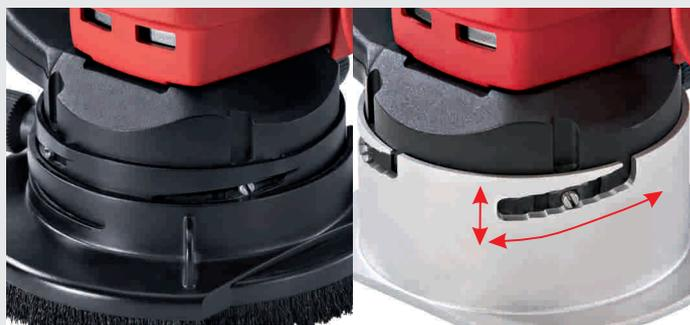
Регулировка по высоте без использования дополнительного инструмента для быстрой и простой регулировки кожухов на требуемую рабочую глубину. Опора D 80 для фрезерных работ. Всасывающий кожух D 115 с ободом из щеток для шлифовальных работ.
