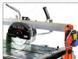
Регулируемая режущая головка
