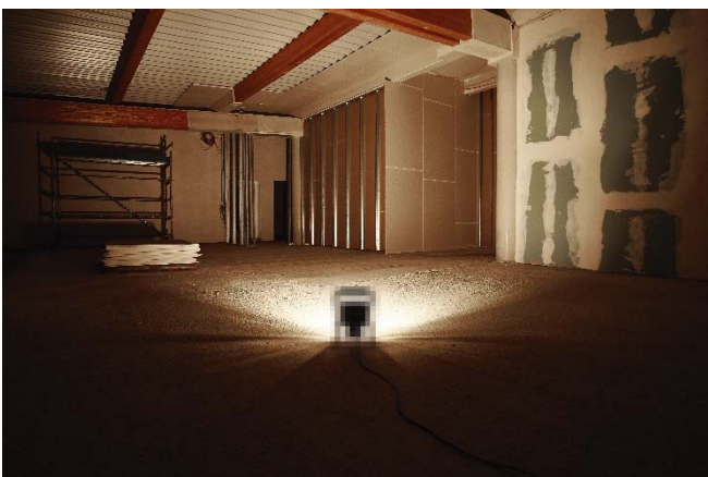
Классическая галогеновая лампа Цветовой фон жёлтый, угол рассеивания меньше.
