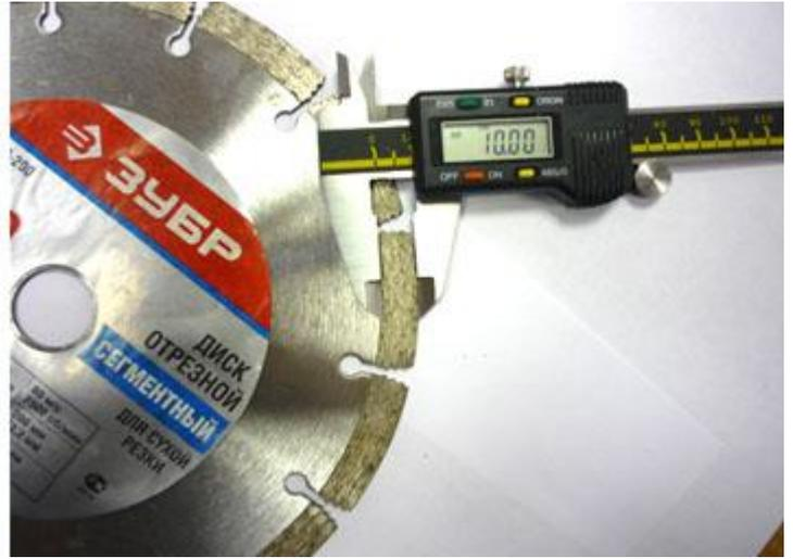
Высота режущего сегмента контрафактного круга составляет стандартные 7мм, в то время как оригинальный продукт имеет высоту сегмента 10мм. Данную разницу можно с легкостью определить даже невооруженным глазом.
