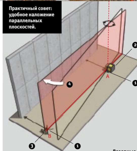
Для этой цели Вы должны иметь в распоряжении лазерный прибор LAR 250 с дистанционным управлением, складную линейку и ресивер REC 300 Digital.
