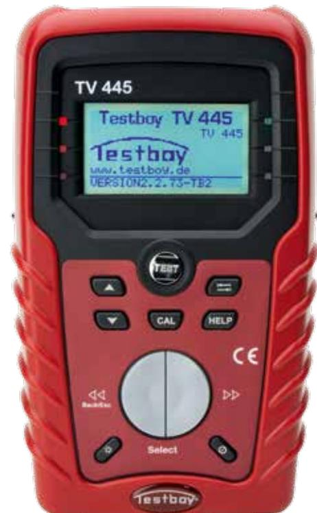
Монтажный тестер, прибор и тестер вращающегося поля, адаптер
