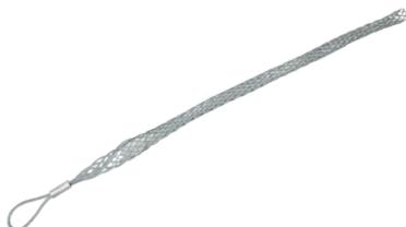
Предназначен для раскатки проводов СИП на опорах и подтяжке проводов на поворотах линии. Наружный диаметр СИП 25-32 мм. Рабочая длина 279 мм. Рабочая нагрузка при натяжении 1590 кг.
