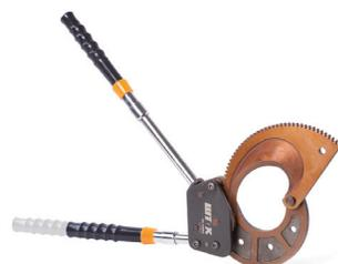
Ножницы секторные HC-110BC предназначены для резки многожильного бронированного медного и алюминиевого кабеля с максимальным диаметром до 110 мм. Вес 6,3 кг.
