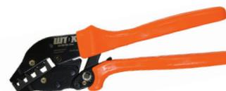
Пресс-клещи ПК-35вт предназначены для опрессовки втулочных наконечников. Диапазон сечений 10, 15, 25, 35 мм<sup>2</sup>. Вес 0,55 кг.
