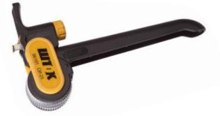
Устройство для снятия изоляции СИ-25 предназначено для снятия изоляции с кабеля диаметром от 25 мм с помощью радиального и продольного надрезов. Максимальная глубина резки 5 мм.
