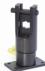
Пресс гидравлический ПГ-300С+ предназначен для опрессовки медных и алюминиевых кабельных наконечников. Сечения: 16, 25, 35, 50, 70, 95, 120, 150, 185, 240, 300 мм<sup>2</sup>. Вес 3,6 кг. **Принадлежности (Таб. 1): Арт. 12053, 12054, 12055.**
