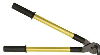
Ножницы кабельные НК-35 предназначены для резки алюминиевого и медного небронированного кабеля максимальным диаметром до 40 мм. Трубчатые рукоятки. Не режет сталь и стальной трос. Вес 1,3 кг.
