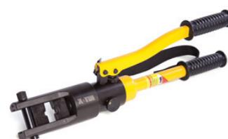
Пресс гидравлический ПГ-300К предназначен для опрессовки медных и алюминиевых наконечников. Сечения: 10, 16, 25, 35, 50, 70, 95, 120, 150, 185, 240, 300 мм<sup>2</sup>. Вес 3,6 кг. **Принадлежности (Таб. 1): Арт. 12053, 12054, 12055.**
