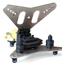
Шиногиб гидравлический ПГШ-125Р+ предназначен для гибки токоведущих шин шириной до 125 и толщиной до 12 мм в вертикальной и горизонтальной плоскостях с помощью подключаемого насоса. Вес 63 кг.
