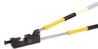
Пресс-клещи механические ПК-240У предназначены для опрессовки кабельных наконечников и гильз сечением 10-240 мм<sup>2</sup>. Универсальные. Револьверная матрица. Вес 3,7 кг.
