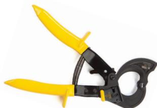
Ножницы секторные НС-32 предназначены для резки многожильного медного и алюминиевого легкобронированного кабеля максимальным диаметром до 32 мм. Не режет сталь и стальной трос. Вес 0,6 кг.
