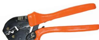
Пресс-клещи ПК-10М предназначены для опрессовки трубчатых наконечников. Диапазон сечений 0,5-1,0, 1,5-2,5, 4,0-6,0, 10 мм<sup>2</sup>. Вес 0,55 кг.
