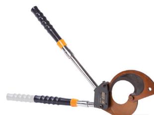
Ножницы секторные HC-75BC предназначены для резки многожильного медного и алюминиевого кабеля максимальным диаметром до 75 мм, в том числе с бронепроводами из стальной оцинкованной проволоки. Вес 3,6 кг.
