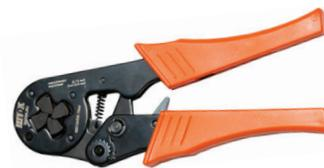
Пресс-клещи ПК-16вт предназначены для опрессовки втулочных наконечников. Диапазон сечений 4-16 мм<sup>2</sup>. Вес 0,52 кг.
