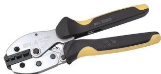
Пресс-клещи ПК предназначены для опрессовки изолированных кабельных наконечников. Диапазон сечений 10, 16, 25, 35 мм<sup>2</sup>. Вес 0,49 кг.
