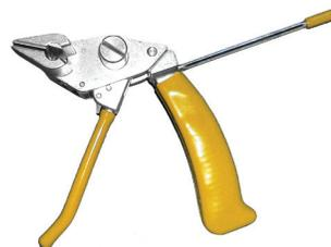
Инструмент для натяжения и резки стальной ленты с храповым механизмом и переставной рукояткой предназначен для крепления кронштейнов, крюков и т.д. с помощью стальной ленты шириной до 19 и толщиной до 0,8 мм.
