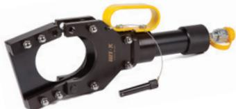
Насадка гидравлическая НГ-85+ предназначена для резки телефонного и небронированного кабеля диаметром 85 мм; бронированного Си и АI кабеля диаметром до 50 мм. Требуется подключение насоса. Вес 7,9 кг.
