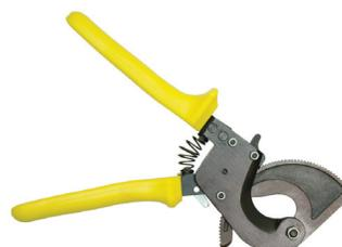
Ножницы секторные НС-32М предназначены для резки многожильного медного и алюминиевого небронированного кабеля максимальным диаметром до 32 мм. Не режет сталь и стальной трос. Вес 0,6 кг.
