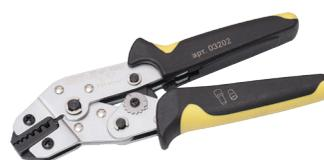
Пресс-клещи ПК предназначены для опрессовки изолированных втулочных наконечников. Диапазон сечений 0.25-0.5, 0.5-0.75, 1.0-1.5, 4.0, 6.0 мм<sup>2</sup>. Вес 0,4 кг.
