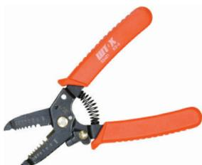
Клещи электромонтажные КЭ-6 предназначены для резки провода и снятия изоляции. Снятие изоляции без повреждения жилы. Возвратная пружина. Фиксатор ручек. Резка проводов до 6 мм.
