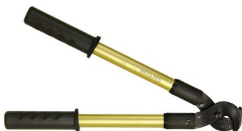
Ножницы кабельные НК-25 предназначены для резки алюминиевого и медного небронированного кабеля максимальным диаметром до 30 мм. Трубчатые рукоятки. Не режет сталь и стальной трос. Вес 0,3 кг.
