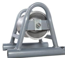
Ролик кабельно-линейный с боковыми дугами РКЛ-55. Алюминиевый ролик и рама исполнены из цельной гнутой трубы с гальваническим цинковым покрытием и с закрытым шариковым подшипником. Вес 4,5 кг.
