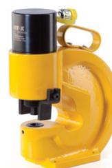
Шинный перфоратор ШП-110/12+ предназначен для перфорирования медных и алюминиевых токоведущих шин толщиной до 12 мм. Комплект матриц: 3/8" (Ø10,5); 1/2" (Ø13,8); 5/8" (Ø17); 3/4" (Ø20,5) дюйм(мм). Вес 33,3 кг.
