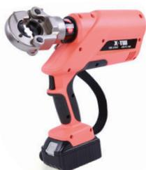
Пресс электрогидравлический аккумуляторный ПЭГА-300 предназначен для опрессовки медных и алюминиевых кабельных наконечников. Сечения: 16, 25, 35, 50, 70, 95, 120, 150, 185, 240, 300 мм<sup>2</sup>.
