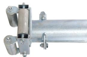
Вводной ролик для кабеля РВК-90-110 исполнен из трубы с гальваническим цинковым покрытием. Диаметр трубы 90 - 110 мм. Вес 5 кг.
