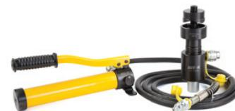
Комплект: гидравлическая насадка-перфоратор ПГЛ-60Н с насосом для перфорации листового металла толщиной до 3 мм. Диаметр перфорации, мм: 22; 28; 34; 43; 49; 60,5. Вес 5,6 кг.
