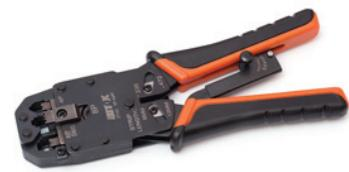
Кримпер универсальный КР-468У предназначен для резки плоского провода и витой пары; снятия внешней изоляции. Диапазон сечений 8P8C/RJ4, 11.68 мм, 6P6C/RJ12, 6P4C/RJ11 (9.65 мм), 4P4C&4P2C/RJ10 (7.65 мм)
