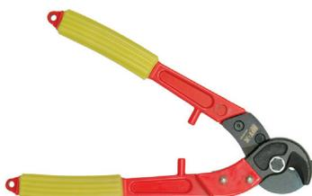
Ножницы кабельные НК-30М предназначены для резки алюминиевого и медного небронированного кабеля максимальным диаметром до 30 мм. Не режет сталь и стальной трос. Вес 0,7 кг.
