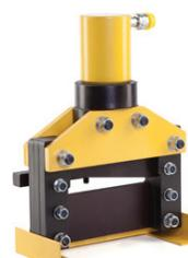
Шинорез гидравлический ШР-200+ предназначен для резки медных и алюминиевых токоведущих шин толщиной до 12 мм и шириной до 200 мм с помощью подключаемого насоса. Требуется подключение насоса. Вес 32,5 кг.
