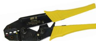
Пресс-клещи ПК-6И предназначены для опрессовки медных и алюминиевых кабельных наконечников сечением 0,5-6 мм<sup>2</sup>. Диапазон сечений 0,5-1,5, 1,1-2,5, 2,6-6,0 мм<sup>2</sup>. Вес 0,6 кг.
