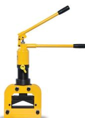
Шинорез гидравлический ШР-150AM предназначен для резки медных и алюминиевых токоведущих шин толщиной до 10 мм и шириной до 150 мм. Автономный. Возможно подключение дополнительного выносного насоса. Вес 29 кг.
