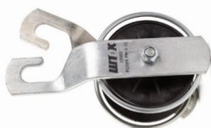
Используют на прямых участках линии и при малых углах до 30°. Катушка изготовлена из стеклонеполненных полиамидов. Раздвигающийся (вращающийся) крюк. Ширина желоба 50 мм. Вес 1,5 кг.
