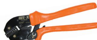
Пресс-клещи ПК-6вт предназначены для опрессовки втулочных наконечников. Диапазон сечений 0,5-1,0, 1,5-2,5, 4,0-6,0, 10,0 мм<sup>2</sup>. Вес 0,55 кг.
