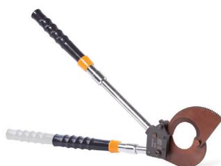
Ножницы секторные HC-50BC предназначены для резки многожильного медного и алюминиевого бронированного кабеля, А и АС провода максимальным диаметром до 50 мм. Вес 2,32 кг.
