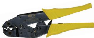
Пресс-клещи ПК-10 предназначены для опрессовки кабельных наконечников и гильз сечением 0,5-10 мм. Диапазон сечений 0,5-1,0, 1,5-2,5, 4,0-6,0, 10,0 мм<sup>2</sup>. Вес 0,6 кг.
