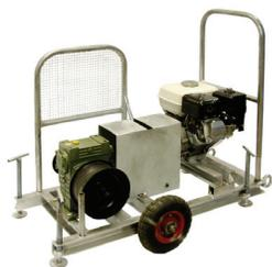
Предназначена для раскатки СИП. Рым-болты для дополнительной фиксации. Защитная решетка. Колеса для удобства перемещения. Рым-болты для дополнительной фиксации. Вес 40 кг.
