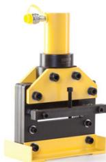
Шинорез гидравлический ШР-150M+ предназначен для резки медных и алюминиевых токоведущих шин толщиной до 10 мм и шириной до 150 мм с помощью подключаемого насоса. Требуется подключения насоса. Вес 29 кг.
