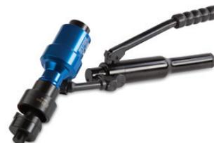
Перфоратор механический ПГЛ-60 предназначен для перфорации листового металла толщиной до 3 мм. Диаметр перфорации, мм: 22; 28; 34; 43; 49; 60,5. Вес 2,1 кг.
