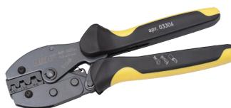
Пресс-клещи ПК предназначены для опрессовки неизолированных коннекторов (автоклеммы) (НК, РГП, РГМ). Диапазон сечений 0.5-1, 1-2.5, 4.0-6.0 мм<sup>2</sup>. Вес 0,49 кг.
