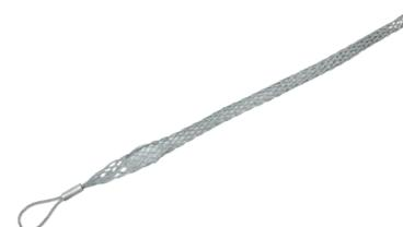
Предназначен для раскатки проводов СИП на опорах. Наружный диаметр СИП 37-50 мм. Рабочая длина 406 мм. Рабочая нагрузка при натяжении 1810 кг.
