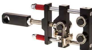
Устройство СИ-70 предназначено для снятия с силовых кабелей диаметром 30-70 мм оболочки и основной изоляции из сшитого полиэтилена. Запасные лезвия в комплекте.
