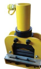
Шинорез гидравлический ШР-150+ предназначен для резки медных и алюминиевых токоведущих шин толщиной до 10 мм и шириной до 150 мм с помощью подключаемого насоса. Требуется подключение насоса. Вес 25,9 кг.
