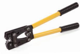
Пресс-клещи механические ПК-50 предназначены для ручной опрессовки алюминиевых и медных кабельных наконечников с помощью встроенных револьверных матриц. Сечения: 6, 10, 16, 25, 35, 50 мм<sup>2</sup>. Вес 1,4 кг.
