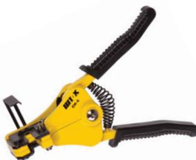
Устройство для снятия изоляции СИ-6 предназначено для снятия изоляции с провода с одно- или многопроволочными жилами сечением от 0,75 до 6 мм<sup>2</sup>. Силуминовый корпус. Возвратная пружина. Вес 0,37 кг.
