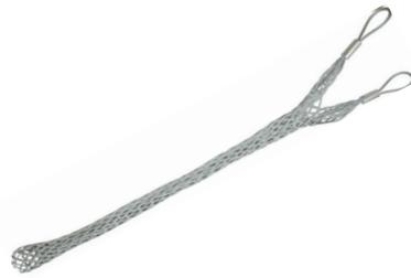
Предназначен для раскатки проводов СИП с удвоенным тяговым усилием. С двумя проушинами. Наружный диаметр СИП 60-75 мм. Рабочая нагрузка при натяжении 2000 кг.
