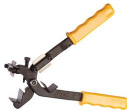
Устройство для снятия изоляции СИ-30 предназначено для снятия изоляции с кабеля диаметром до 30 мм с помощью радиального и продольного надрезов. Вес 0,69 кг.
