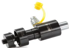
Насадка гидравлическая ПГЛ-60+ предназначена для перфорации листового металла толщиной до 3 мм. Диаметр перфорации, мм: 22; 28; 34; 43; 49; 60,5. Требуется подключение насоса. Вес 0,8 кг.
