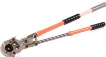
Пресс-клещи механические ПК-300М предназначены для ручной опрессовки алюминиевых и медных кабельных наконечников. Сечения: 16, 25, 35, 50, 70, 95, 120, 150, 185, 240, 300 мм<sup>2</sup>. Вес 5,5 кг. **Принадлежности (Таб. 1): Арт. 12101, 12102, 12103.**
