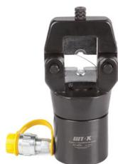
Пресс гидравлический ПГ-400+ предназначен для опрессовки медных и алюминиевых кабельных наконечников с помощью подключаемого гидравлического насоса. Сечения: 16, 25, 35, 50, 70, 95, 120, 150, 185, 240, 300, 400 16-400 мм<sup>2</sup>. **Принадлежности (Таб. 1): Арт. 12056.**
