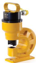
Шинный перфоратор ШП-95+ предназначен для перфорирования медных и алюминиевых токоведущих шин толщиной до 10 мм. Комплект матриц: 3/8" (Ø10,5); 1/2" (Ø13,8); 5/8" (Ø17); 3/4" (Ø20,5) дюйм(мм). Вес 16,9 кг.
