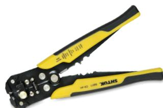
Устройство для снятия изоляции СИ-6Н предназначено для резки провода, снятия изоляции, опрессовки наконечников. Резка проводов до 0,25-6,0 мм<sup>2</sup>. Опрессовка: 0,5-2,5 / 0,5-6,0 мм<sup>2</sup>. Вес 0,45 кг.
