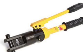
Пресс гидравлический ПГ-120К предназначен для опрессовки медных и алюминиевых наконечников. Сечения: 10, 16, 25, 35, 50, 70, 95, 120 мм<sup>2</sup>. Вес 2,7 кг. **Принадлежности (Таб. 1): Арт. 12051.**
