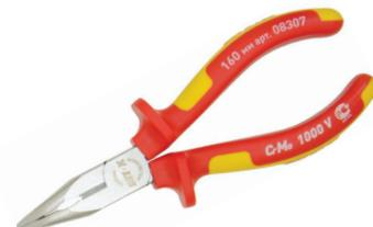
Предназначены для выгибания петель из медного и алюминиевого провода, в том числе под действующим напряжением до 1000В. Губки отогнуты под углом 40°.
