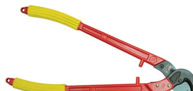
Ножницы кабельные НК-40М предназначены для резки алюминиевого и медного небронированного кабеля максимальным диаметром до 40 мм. Не режет сталь и стальной трос. Вес 1,8 кг.
