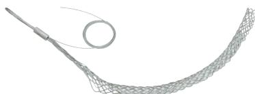
Предназначен для раскатки проводов СИП на опорах. Открытый. Наружный диаметр СИП 25-32 мм. Общая длина 584 мм. Рабочая нагрузка при натяжении 1590 кг.
