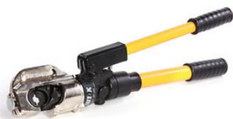
Пресс гидравлический ПГ-400 предназначен для опрессовки медных и алюминиевых наконечников. Сечения: 50, 70, 95, 120, 150, 185, 240, 300, 400 мм<sup>2</sup>. Вес 7 кг.
