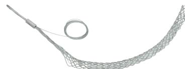
Предназначен для раскатки проводов СИП на опорах. Открытый. Наружный диаметр СИП 18-50 мм. Рабочая длина 305 мм. Рабочая нагрузка при натяжении 1130 кг.
