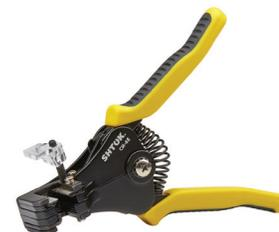
Устройство для снятия изоляции СИ-6Е предназначено для снятия изоляции с провода с одно- или многопроволочными жилами сечением от 0,75 до 6 мм<sup>2</sup>. Эргономичная форма ручек. Силуминовый корпус. Возвратная пружина. Вес 0,39 кг.
