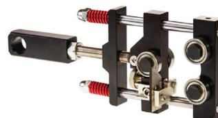
Устройство СИ-50 предназначено для снятия с силовых кабелей диаметром 15-50 мм оболочки и основной изоляции из сшитого полиэтилена. Запасные лезвия в комплекте.
