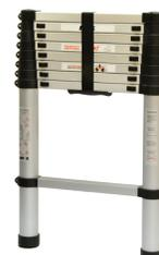
Изготовлена из высококачественного дюралюминия и первичного (непереработанного) пластика. Длина 2,6 м. Длина в сложенном виде 0,71 м. Максимальная нагрузка 150 кг. Вес 7,4 кг.
