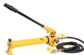
Насос гидравлический НГР-7009К предназначен для создания рабочего давления в прессах с одноконтурным принципом нагнетания. Объем масла 0,9 л. Габариты 510x140x150 мм. Вес 9 кг.
