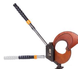
Ножницы секторные HC-90BC предназначены для резки многожильного бронированного медного и алюминиевого кабеля с максимальным диаметром до 95 мм. Не режет сталь и стальной трос. Вес 4,2 кг.
