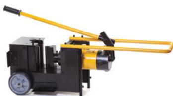
Станок гидравлический ПГШ-150 предназначен для резки, гибки и перфорации токоведущих шин шириной до 150 мм и толщиной до 12 мм с помощью встроенного насоса. Универсальный. Вес 30 кг.
