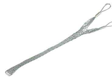
Предназначен для раскатки проводов СИП с удвоенным тяговым усилием. С двумя проушинами. Наружный диаметр СИП 60-75 мм. Рабочая нагрузка при натяжении 2500 кг.
