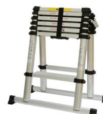
Легкая и надежная конструкция. Изготовлена из высококачественного дюралюминия и первичного пластика. Длина 2 м. Длина в сложенном виде 0,86 м. Максимальная нагрузка 150 кг. Вес 10,8 кг.
