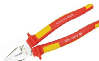
Предназначены для захвата и удержания плоских, цилиндрических поверхностей, гаек. Приближенный к оси шарнир обеспечивает на 42% больше усилия на губках, чем обычные плоскогубцы.
