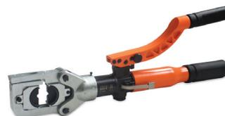
Пресс гидравлический ПГ-300У предназначен для опрессовки медных и алюминиевых наконечников. Сечения: 16, 25, 35, 50, 70, 95, 120, 150, 185, 240, 300 мм<sup>2</sup>. Вес 4,5 кг. **Принадлежности (Таб. 1): Арт. 12101, 12102, 12103. Также см. Таб. 2.**
