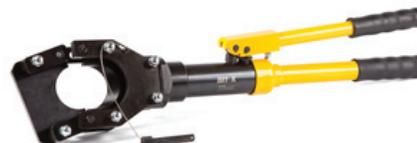
Ножницы гидравлические НГ-52Б предназначены для резки медного и алюминиевого кабеля (в том числе бронированного) диаметром до 45 мм и телефонного кабеля до 50 мм. Вес 7,1 кг.
