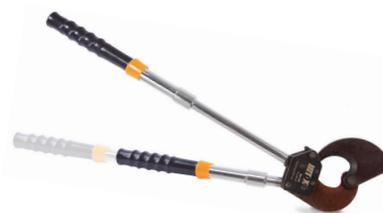
Ножницы секторные HC-14C предназначены для резки А и АС провода диаметром до 30 мм, стального троса диаметром до 11 мм и стальной цепи из низкоуглеродистой стали. Не режет медный и алюминиевый кабель. Вес 1,97 кг.
