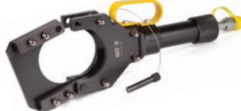
Насадка гидравлическая НГ-100+ предназначена для резки телефонного и небронированного кабеля диаметром до 100 мм; бронированного Си и АI кабеля диаметром до 75 мм. Требуется подключение насоса. Вес 8,4 кг.
