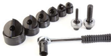
Перфоратор механический ПМЛ-60 предназначен для перфорации листового металла толщиной до 1,5 мм. Диаметр перфорации, мм: 22,5; 28,3; 34,6; 43,2; 49,6; 61,5. Вес 2,1 кг.
