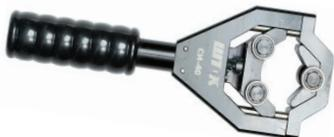
Устройство СИ-40 для снятия изоляции с силовых кабелей защитной оболочки и основной изоляции из сшитого полиэтилена диаметром 15-40 мм. В комплекте 2 запасных ножа.
