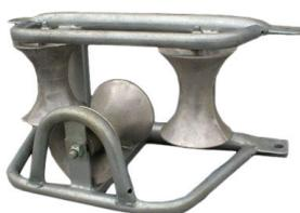
Ролик кабельно-угловой РКУ-55. Алюминиевый ролик и рама исполнены из цельной гнутой трубы с гальваническим цинковым покрытием и с закрытым шариковым подшипником. Вес 12 кг.
