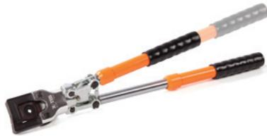
Пресс-клещи механические ПК-150 предназначены для ручной опрессовки алюминиевых и медных кабельных наконечников. Сечения: 10, 16, 25, 35, 50, 70, 95, 120, 150 мм<sup>2</sup>. Вес 2,5 кг. **Принадлежности (Таб. 1): Арт. 12051.**
