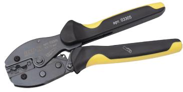
Пресс-клещи ПК предназначены для опрессовки неизолированных медных кабельных наконечников диаметром 0.5-1, 1.5-2.5, 4.0-6.0, 8.0-10.0 мм<sup>2</sup>. Вес 0,49 кг.
