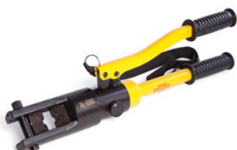
Пресс гидравлический ПГ-300 предназначен для опрессовки медных и алюминиевых наконечников. Сечения: 10, 16, 25, 35, 50, 70, 95, 120, 150, 185, 240, 300 мм<sup>2</sup>. Вес 3,6 кг. **Принадлежности (Таб. 1): Арт. 12053, 12054, 12055.**
