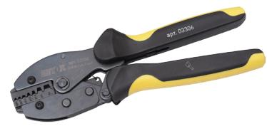
Пресс-клещи ПК предназначены для опрессовки изолированных втулочных наконечников (НШВИ(2)) диаметром 2x0.5, 2x0.75, 2x1.0, 2x1.5, 2x2.5, 2x4, 2x6 мм<sup>2</sup>. Вес 0,49 кг.
