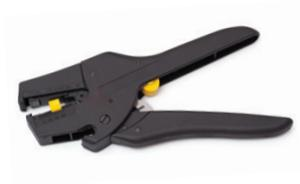
Устройство для снятия изоляции автоматическое СИ-6Т предназначено для резки провода, снятия внешней оболочки и изоляции с круглого и плоского многожильного провода до Ø 6 мм<sup>2</sup>. Максимальная регулируемая длина снятия изоляции 15 мм.
