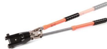
Пресс-клещи механические ПК-240М предназначены для ручной опрессовки алюминиевых и медных кабельных наконечников. Сечения: 25, 35, 50, 70, 95, 120, 150, 185, 240 мм<sup>2</sup>. Вес 3,8 кг. **Принадлежности (Таб. 1): Арт. 12053, 12054, 12055.**
