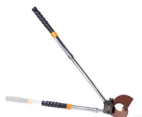
Ножницы секторные HC-33Т предназначены для резки стального троса диаметром до 33 мм. Возможность разблокировать подвижное секторное лезвие на любом этапе. Не режет медный и алюминиевый кабель. Вес 5,14 кг.
