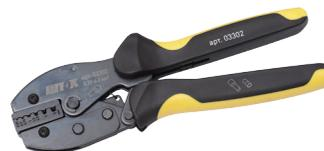
Пресс-клещи ПК предназначены для опрессовки изолированных кабельных наконечников. Диапазон сечений 0.25, 0.5-0.75, 1-1.5, 2.5, 4.0-6.0 мм<sup>2</sup>. Вес 0,49 кг.
