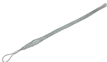
Предназначен для раскатки проводов СИП на опорах. Наружный диаметр СИП 37-50 мм. Рабочая длина 432 мм. Рабочая нагрузка при натяжении 1810 кг.
