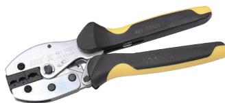
Пресс-клещи ПК предназначены для опрессовки изолированных наконечников. Диапазон сечений 0.5-1.5, 2.5, 4.0-6.0 мм<sup>2</sup>. Вес 0,49 кг.
