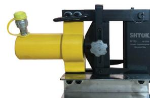
Шиногиб гидравлический ШГ-150+ предназначен для гибки медных и алюминиевых токоведущих шин толщиной до 10 мм и шириной до 150 мм. Оснащен сменным гибочным углом R5 и R10. Требуется подключение насоса. Вес 19,2 кг.
