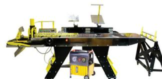
Линия полуавтоматическая ЛПА-6РШ для резки шины в комплекте с шинорезом и маслостанцией SHTOK. предназначена для резки токоведущих алюминиевых и медных шин в ручной и полуавтоматическом режимах. Готовый комплект, не требующий дополнительных приспособлений. Вес 300 кг.
