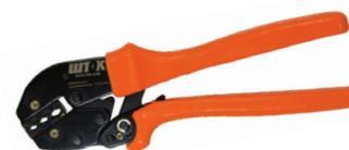
Пресс-клещи ПК-6иМ предназначены для опрессовки изолированных втулочных наконечников. Диапазон сечений 0,5-1,5, 1,5-2,5, 2,6-6,0 мм<sup>2</sup>. Вес 0,55 кг.
