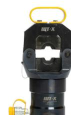
Пресс гидравлический ПГ-630+ предназначен для опрессовки медных и алюминиевых кабельных наконечников, а также аппаратных зажимов. Сечения: 150, 185, 240, 300, 400, 500, 630 мм<sup>2</sup>. Вес 17 кг. **Принадлежности (Таб. 1): Арт. 12057, 12058.**
