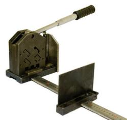
Устройство РРУ-40 предназначено для резки DIN-реек и направляющих реек шириной до 35 мм, перфорации продольных и поперечных отверстий в DIN-рейке для крепежа, резки перфорированного кабель-канала.
