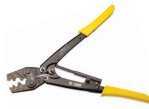
Пресс-клещи ПК-16 предназначены для опрессовки кабельных наконечников и гильз. Автоматический контроль опрессовки. Сечения: 1.5, 2.0, 6, 10, 16 мм<sup>2</sup>.
