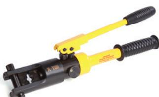
Пресс гидравлический ПГ-120 предназначен для опрессовки медных и алюминиевых наконечников. Сечения: 10, 16, 25, 35, 50, 70, 95, 120 мм<sup>2</sup>. Вес 2,7 кг. **Принадлежности (Таб. 1): Арт. 12051.**
