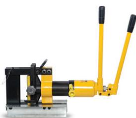
Шиногиб гидравлический ШГ-150А предназначен для гибки медных и алюминиевых токоведущих шин толщиной до 10 мм и шириной до 150 мм. Автономный. Возможно подключение дополнительного выносного насоса. Вес 30 кг.
