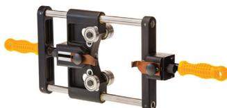
Устройство СИ-150 предназначено для снятия с силовых кабелей диаметром 90-150 мм оболочки и основной изоляции из сшитого полиэтилена. Запасные лезвия в комплекте.
