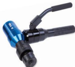
Перфоратор механический ПГЛ-60Т предназначен для перфорации листового металла толщиной до 3 мм. Диаметр перфорации, мм: 22; 28; 34; 43; 49; 60,5. Вес 2,2 кг.
