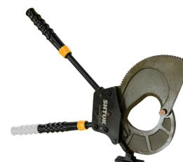
Ножницы секторные HC-130BC предназначены для резки многожильного бронированного медного и алюминиевого кабеля с максимальным диаметром до 130 мм, в том числе бронированного. Вес 8,11 кг.
