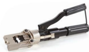
Пресс гидравлический ПГ-150М предназначен для опрессовки медных и алюминиевых наконечников. Сечения: 10, 16, 25, 35, 50, 70, 95, 120, 150 мм<sup>2</sup>. Вес 2,4 кг. **Принадлежности (Таб. 1): Арт. 12113, 12159.**
