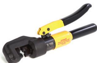
Пресс гидравлический ПГ-70 предназначен для опрессовки медных и алюминиевых наконечников. Сечения: 4, 6, 8, 10, 16, 25, 35, 50, 70 мм<sup>2</sup>. Вес 1,2 кг. **Принадлежности (Таб. 1): Арт. 12051.**
