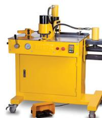
Станок универсальный гидравлический СРШ-150 предназначен для резки, гибки и перфорации токоведущих шин толщиной до 12 мм и шириной до 200 мм. Комплект матриц: 3/8" (Ø10,5); 1/2" (Ø13,8); 5/8" (Ø17); 3/4" (Ø20,5). Вес 240 кг.
