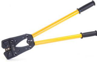
Пресс-клещи механические ПК-120 предназначены для ручной опрессовки алюминиевых и медных кабельных наконечников с помощью встроенных револьверных матриц. Сечения: 16, 25, 35, 50, 70, 95, 120 мм<sup>2</sup>. Вес 3,8 кг.
