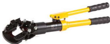
Ножницы гидравлические НС-40С предназначены для резки провода А и АС диаметром до 40 мм и стального троса диаметром до 20 мм. Откидная головная часть позволяет заводить ножницы на кабель в любом месте. Вес 3,3 кг.
