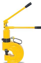
Шинный перфоратор ШП-70A предназначен для перфорирования медных и алюминиевых токоведущих шин толщиной до 10 мм. Автономный. Комплект матриц: 3/8" (Ø10,5); 1/2" (Ø13,8); 5/8" (Ø17); 3/4" (Ø20,5) дюйм(мм). Вес 37 кг.
