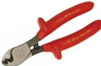
Предназначен для резки алюминиевого и медного одножильного и многожильного кабеля диаметром до 12 мм без деформации и замятия краев. Диэлектрические ручки из двухслойного пластизоля.
