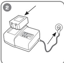
Убедитесь, что температура окружающего воздуха в помещении 10-40°C. Вставьте аккумулятор в зарядное устройство, а штекер в розетку 230 В/50 Гц
