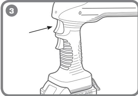
**3** Нажмите на кнопку «ПУСК» и держите нажатой ее до срабатывания механизма автоматического сброса давления. При этом раздаётся характерный щелчок.
