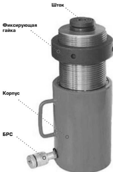
Домкрат состоит из корпуса, фиксирующей гайки, штока и быстроразъемного соединения БРС.
