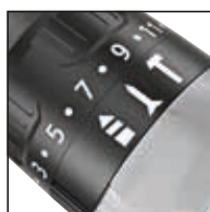
Регулятор крутящего момента 25 позиций для изменения крутящего момента и регулировка под сверла для правильного выбора мощности инструмента. Ударная дрель PD 2G 18.0 оснащена функцией регулировки удара в зависимости от рабочей поверхности (для кирпича, камня или бетона)
