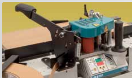
Элементы управления: Электронная регулировка температуры, скорости, держатель кромочного материала и ручной торцевой подрезатель.
