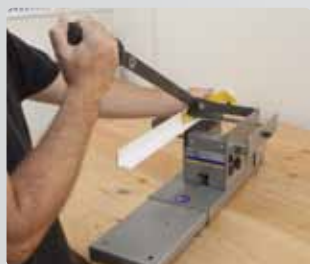
Быстрая, чистая и безопасная обрезка без электростатической пластиковой пыли.
