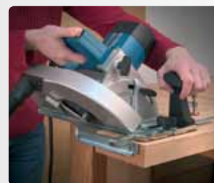
Выполнение наклонного реза.
