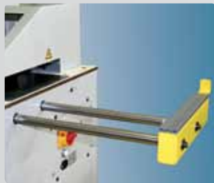
Выдвижная опора для больших деталей.
