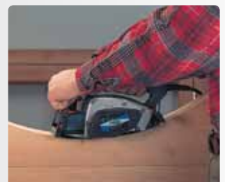
Строгание вогнутых поверхностей.
