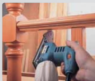
Использование дельтообразной подошвы для обработки труднодоступных мест.
