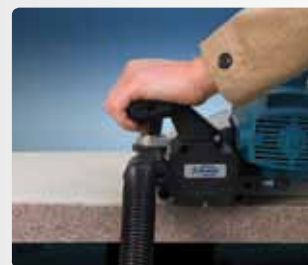
Обработка кромочных планок из искусственного камня.
