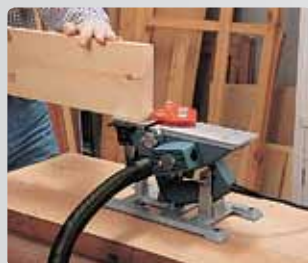
Основание для использования рубанка в стационарном положении с защитой ножей.
