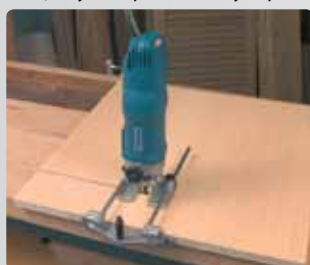
Прорезка параллельных пазов с помощью универсального упора
