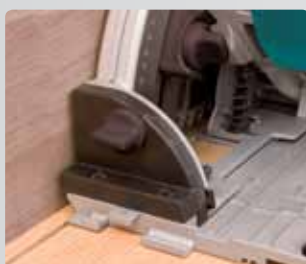
Минимальное расстояние от стены до линии пропила составляет 13,5 мм.
