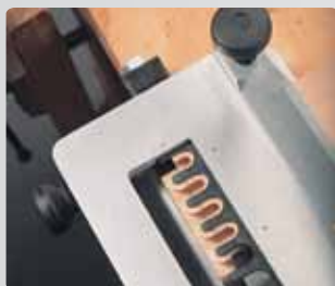
Начальная точка фрезерования шипов может регулироваться
