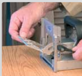
Угол и высота регулируется по встроенным шкалам.
