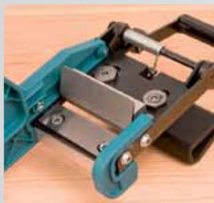
Система удаления свесов кромочного материала гильотинного типа.
