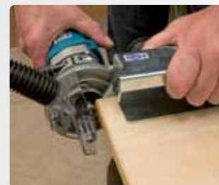
Обработка углов методом обкатки.
