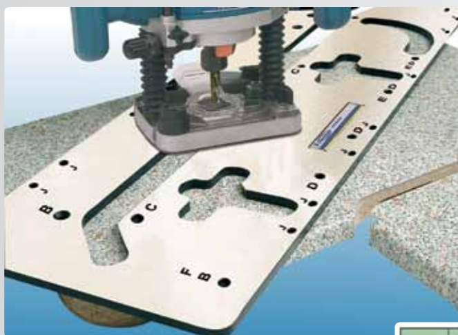
Фрезерование крестообразного паза под стяжку.
