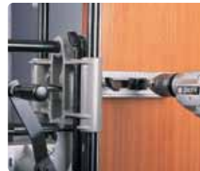
Приспособление UT16I позволяет наметить отверстия для сверления под ручку и запорный цилиндр.
