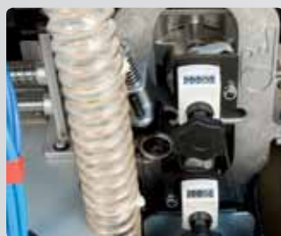
Точная настройка фрез и копира при помощи регуляторов с цифровой индикацией.
