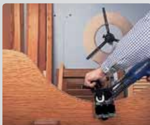
Облицовка вогнутых и выгнутых деталей
