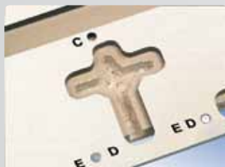
Фрезерование крестообразного паза под стяжку.
