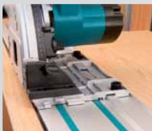
Эксцентрики для выборки зазора между подошвой пилы и направляющей шиной.
