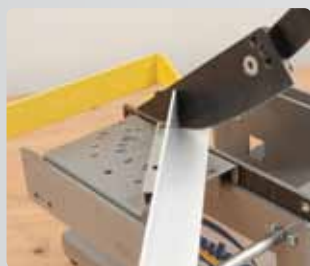
Выполнение углового реза.
