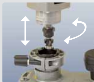
Новая система точной настройки вылета фрезы.
