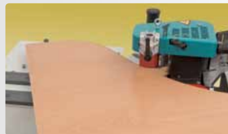
Оснащен дополнительным роликом для облицовки криволинейных деталей.
