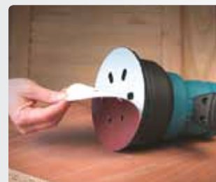
Всасывающие отверстия совместимы с большинством стандартных самофиксирующихся абразивов.
