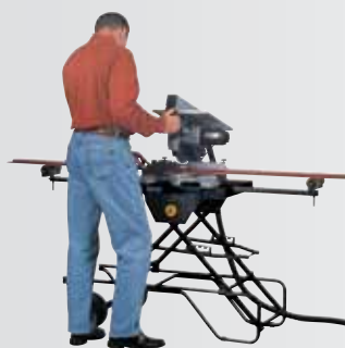
Перенос угла на режущий инструмент.
