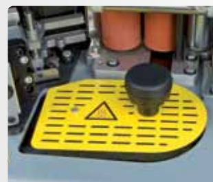
Клеевая ванна со специальным антипригарным покрытием Teflon® с возможностью регулировки количества клея.
