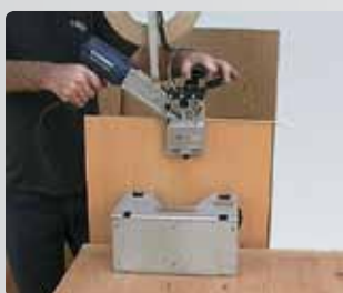
Облицовка вогнутых и выгнутых деталей
