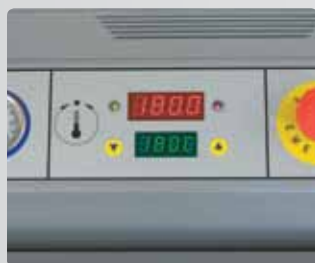
Точная настройка фрез и копира при помощи регуляторов с цифровой индикацией.
