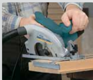
Выполнение наклонного реза.
