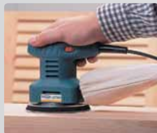
В качестве эксцентриковой машины сочетает два движения: вращательное и вибрационное
