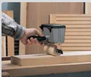
Нанесение винилового (белого) клея
