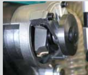
Фреза и копир конструктивно независимы.
