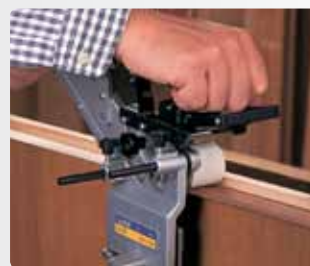
Облицовка внутренней стороны выступа на двери с притвором.
