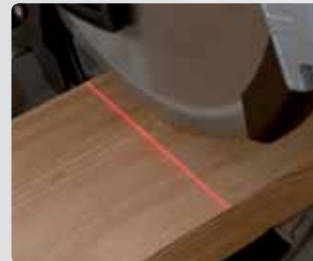
Лазер установлен на прижимной шайбе пильного диска, что обеспечивает точность при любом положении пильного диска.
