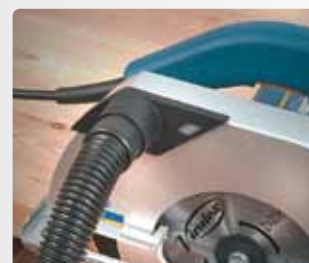
Имеет патрубок для подключения внешнего пылесборника.
