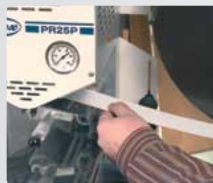
Станок позволяет наносить клей на полосы ламината, пластика или древесисины, без использования модуля намотки.
