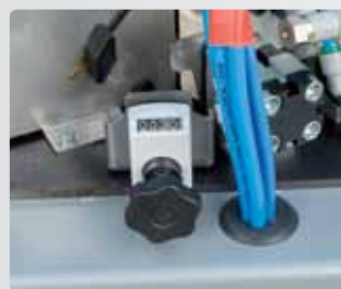
Одновременная настройка на толщину кромочного материала, объема клея и клеенаносящего валика при помощи регуляторов с цифровой индикацией.
