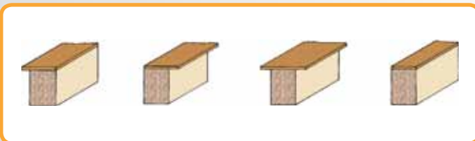
4 возможности распределения свесов кромочного материала
