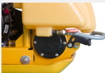
Система орошения предотвратит прилипание основания виброплиты к горячей асфальту.
