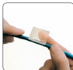
Прозрачную часть этикетки обернуть вокруг провода, перекрыв область с текстом
