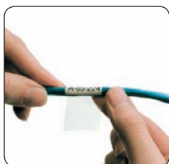
Прозрачную часть этикетки обернуть вокруг провода, перекрыв область с текстом
