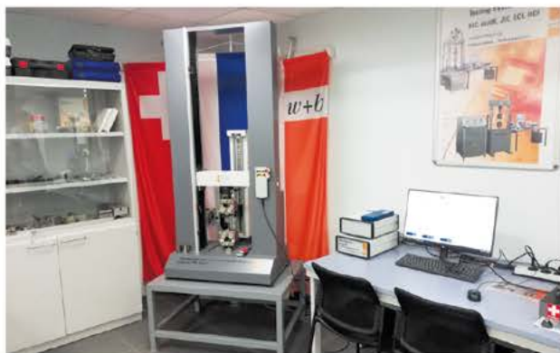
Испытательная разрывная машина фирмы Walter+Bai (Швейцария) применяется для тестирования образцов металлических сплавов
