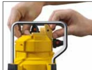
Перевод из горизонтального в вертикальное положение: весь блок призмы поворачивается в направляющем канале точно на 90°.
