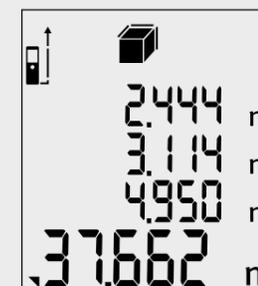
**2. Выполнение обмеров.** Измерьте помещение с помощью функции «Объем». Результат будет указан в кубических метрах.
