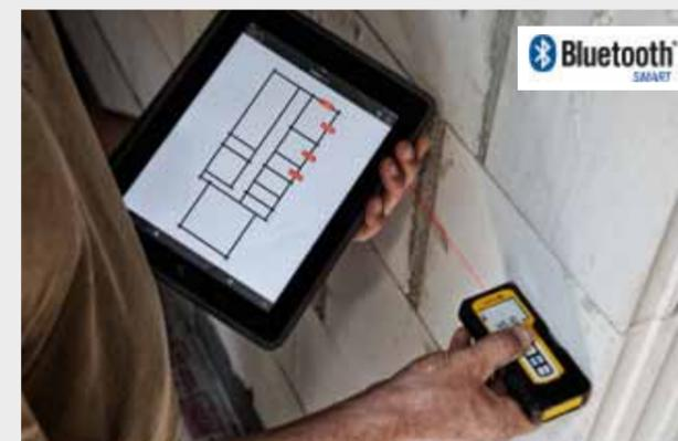
Беспроводное соединение со смартфоном или планшетом благодаря встроенному в LD 250 BT модулю Bluetooth® Smart 4.0. Легкая передача данных с помощью бесплатного приложения STABILA Measures для устройств на платформе iOS или Android.
