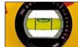
Тип 70 W отлично подходит для строительства металлоконструкций, столярных и других работ по дому. Поворотная **пузырьковая камера для измерения углов**
