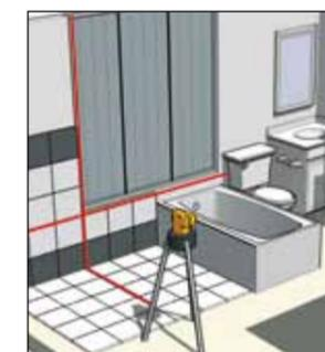
Вы можете быстро сменить местоположение без чьей-либо помощи. Благодаря телескопической штанге-штативу лазерный прибор LAX 50 является действительно универсальным инструментом.
