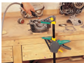
просто выполняемое переоборудование для функции распора
