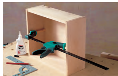
просто выполняемое переоборудование для функции распора
