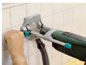
дополнительная рукоятка для точного наведения сверла и помогающая избежать соскальзывания при сверлении
