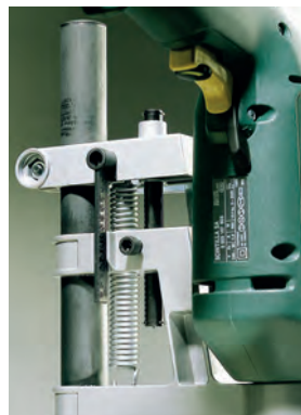
установка глубины сверления с помощью упора ограни- чения глубины
