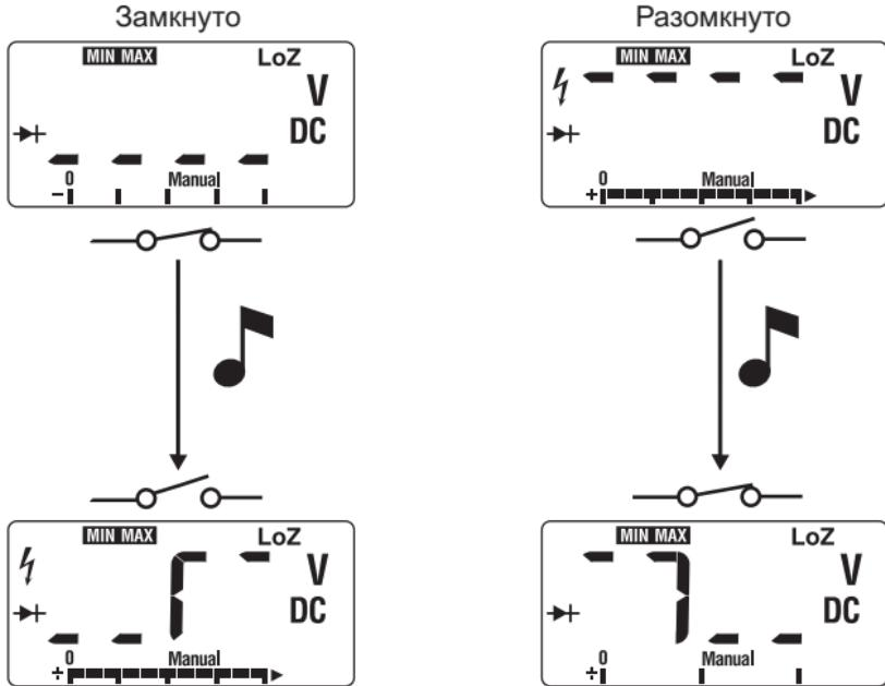
Отслеживание переходных процессов длительностью более 500 мкс (1/2000<sup>ая</sup> секунды).
