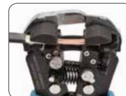
Одновременное снятие изоляции с трех проводов
