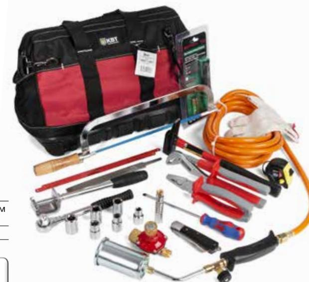
*“Базовый набор для монтажа муфт практически на любых кабелях. Для монтажа на кабелях СПЭ добавьте стриппер из серии КСП (KBT).”*
