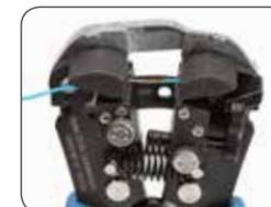
Снятие изоляции с микропровода
