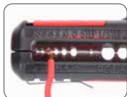
Снятие изоляции с проводов
