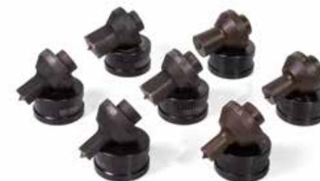
*“Круглые и овальные перфоформы для пробивки отверстий в шинах под винты M6-M20.”*
