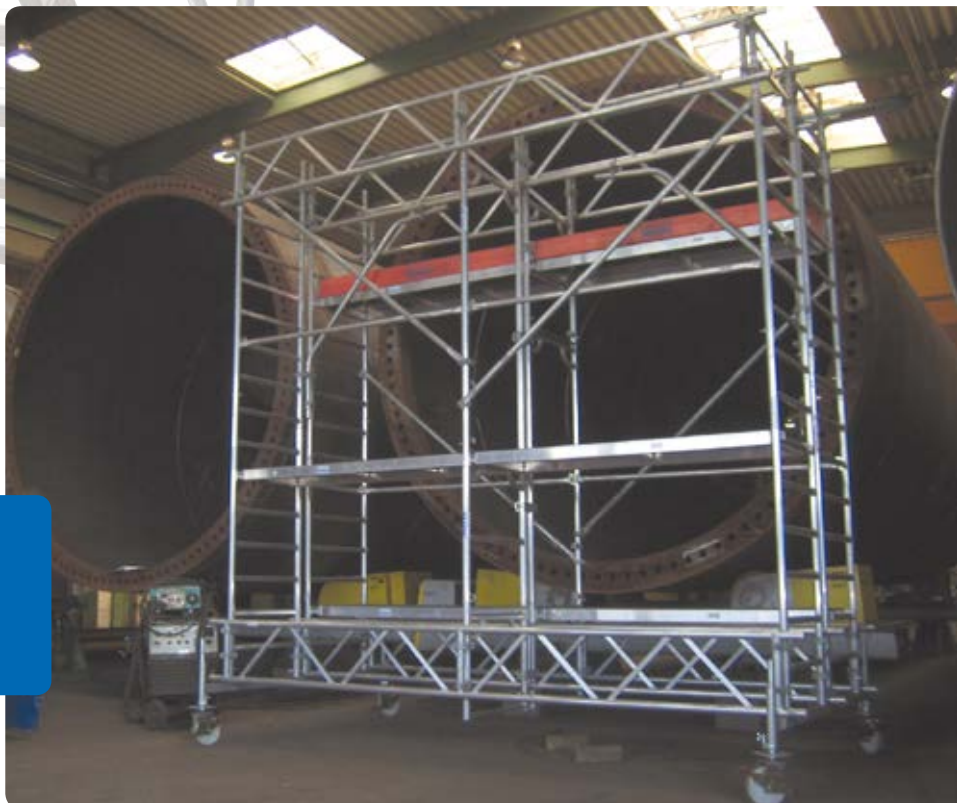
Вышка для обслуживания, передвигается краном
